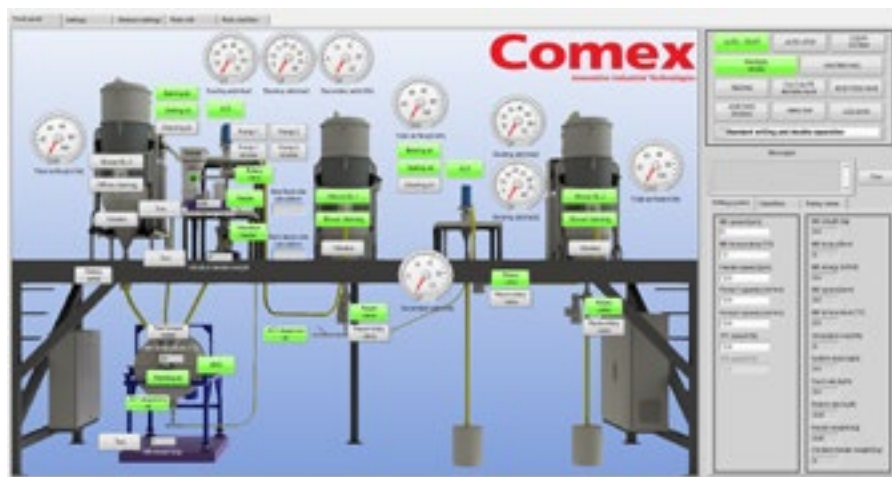
RYS. 3 Frontpanel układu sterowania otwartym systemem mielenia kulowego z podwójną separacją
