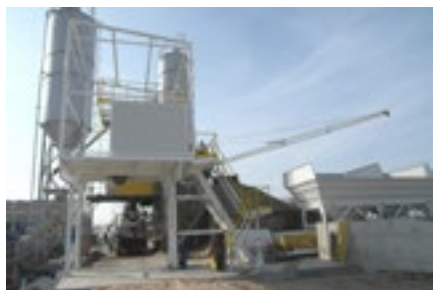
FOT. 9 Stacyjny węzeł betoniarski (źródło: Metpol)
