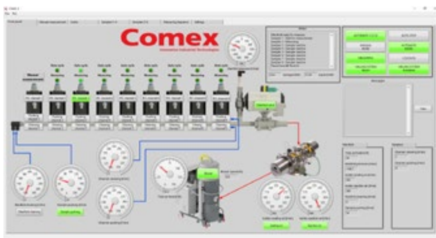
RYS. 4 Frontpanel układu pomiarowego współpracującego z systemami mielącymi BMX-400
