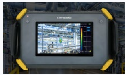
FOT. 8 Wyciek zobrazowany w kamerze akustycznej CRY SOUND
