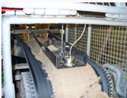
FOT. 3 Pomiar wilgotności piasku metoda pojemnościowa [Zrędo: Mutec Instruments]
