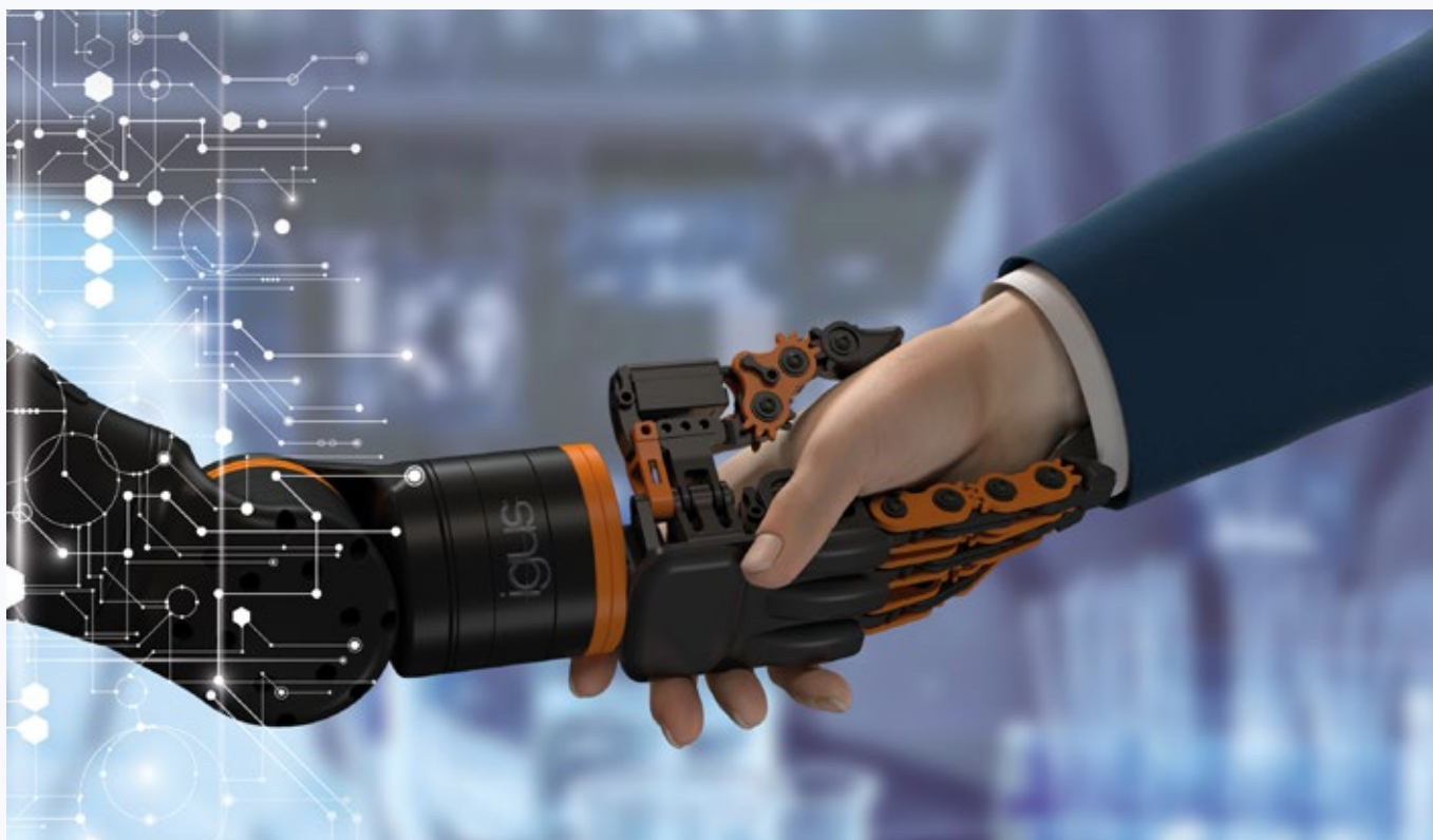
FOT. 1 Firma igus opracowała chwytak palcowy dla cobota ReBeL. ReBeL może wykonywać różne, proste zadania humanoidalne za pomocą nowej ręki robotycznej. (Źródło: igus GmbH)
